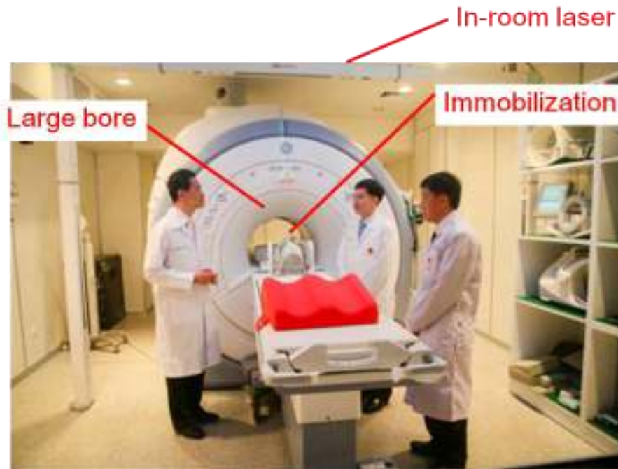
ภาพที่ 5 เครื่อง MRI simulation มี large bore สำหรับ immobilization device และ in-room laser
