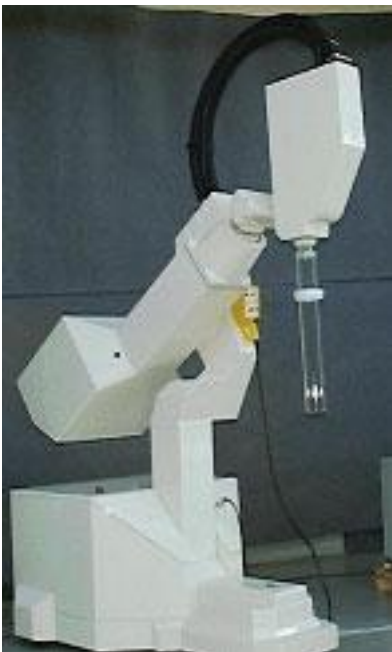
ภาพที่ 10 แสดงเครื่องฉายรังสี electron ในห้องผ่าตัด
